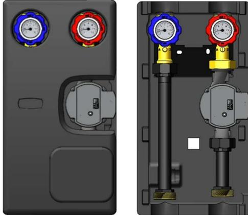
Pumpengruppe ohne Mischung für Heizungssysteme mit einer Leistung bis zu 65 kW. Die Pumpengruppe ist ein fabrik neuer Gerätesatz, der mit einer modernen Wita-Pumpe ausgestattet ist. Thermometer in Kugelhähnen ermöglichen die Temperaturkontrolle, und zusätzlich ist bei niedrigen Parametern ein Rückschlagventil eingebaut, um einen Rückfluss zu vermeiden. Die gesamte Gruppe ist mit Wärmedämmung aus epp eingestellt. Gerät, das sowohl zur montage am Verteiler als auch en der Wand entwickelt wurde.
